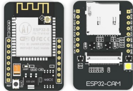
(b) Desenho do módulo baseado no micro-processador ESP32-S. Retirado do datasheet [41]
