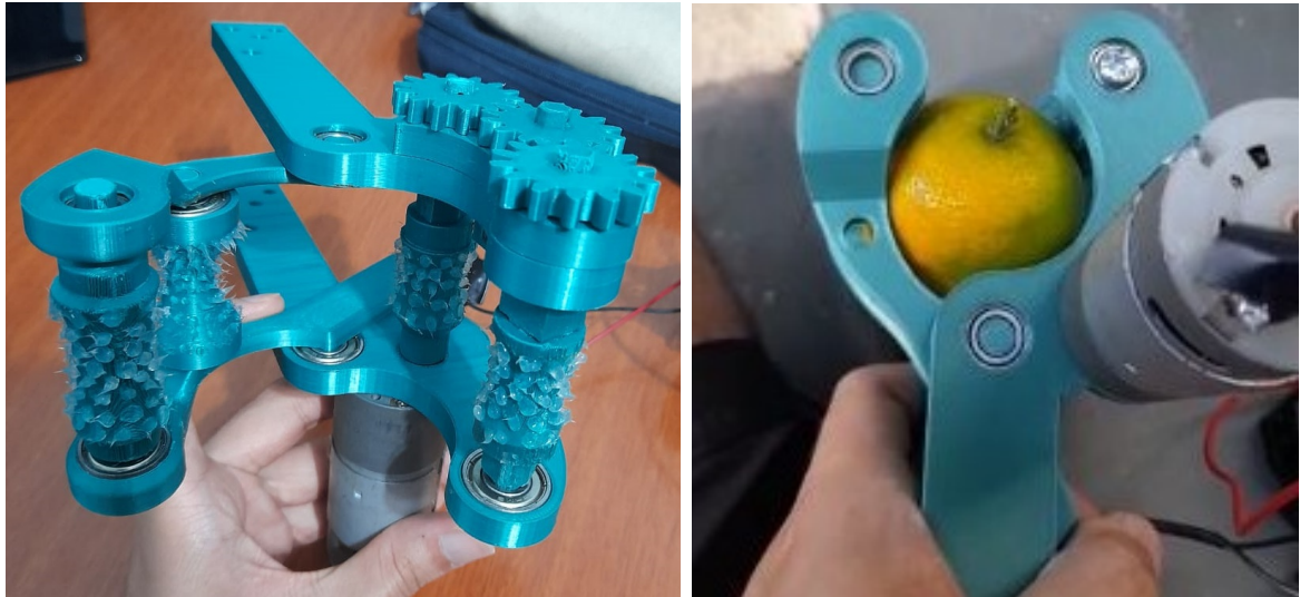
(a) Cravos de silicone utilizados para aumento da aderência (b) Limão colhido com o protótipo preliminar
